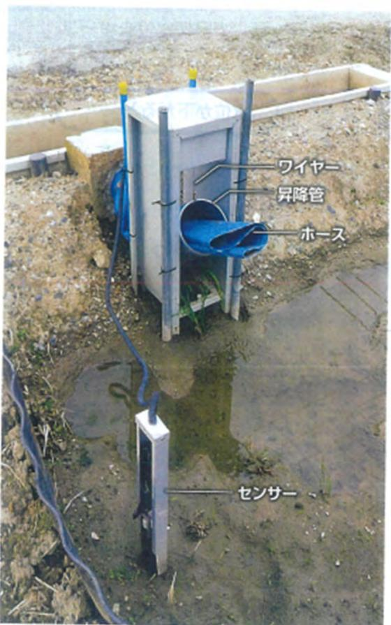
農匠自動給水機。水位センサーに連動してワイヤーで昇降管を動かし、ホースの傾きを変えることで、自動的に入水と止水が切り替わる
